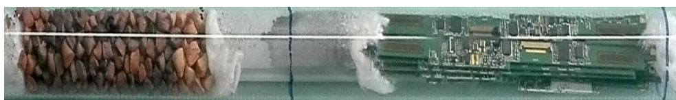
Rys.2. Przygotowany do zgazowania materiał odpadów elektronicznych (inwerterów matrycy) wraz z wypełnieniem strefy wspomagania konwersji gazów (granule po lewej)
