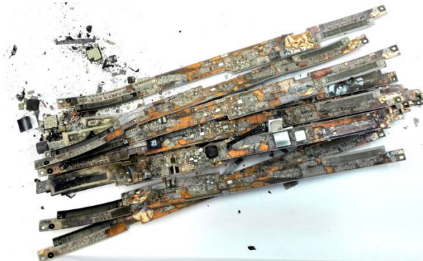
Rys. 4. Materiał inwerterów po procesie zgazowania
