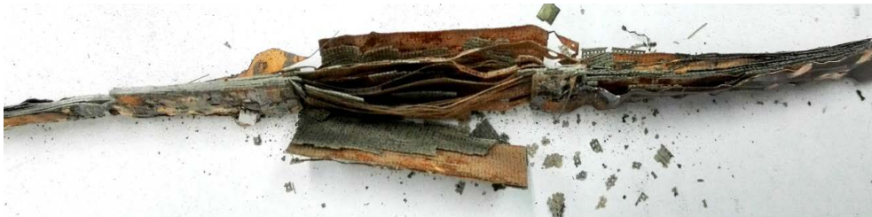
Rys. 5. Otwarta struktura obwodu drukowanego po procesie zgazowania
